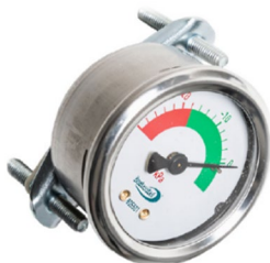
Manometro che indica quando effettuare la pulizia dei filtri (zona rossa a 18 kPa)
