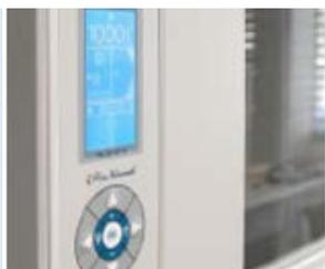
Sensore di controllo e monitoraggio del flusso d'aria Q-Flow Advanced
