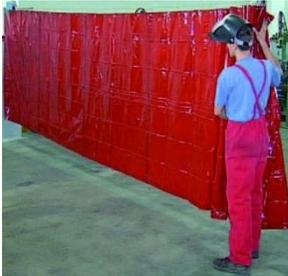
Arrotolatori per sostenere le tende utilizzate per la separazione dei box di lavoro e per farle sparire completamente quando i pezzi in lavorazione devono accedere ai vari box.
