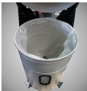
Contenitore di raccolta polveri con bascula per controllo visivo
