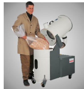
Fusto ribaltabile per facilitare le operazioni di manutenzione
