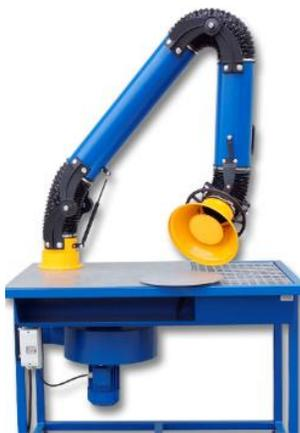
Banco aspirante per fumi di saldatura completo di braccio fissato a banco, da posizionare vicino l'operatore, piano di lavoro con griglia aspirante in posizione centrale o laterale, ventilatore e termica di protezione.
