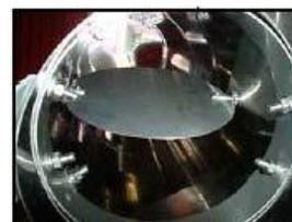
Anello interno di rinforzo per il fissaggio degli snodi e serranda in acciaio montata su perni, pure in acciaio.
