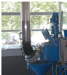
Bracci di aspirazione autoportanti totalmente liberi da impedimenti interni, con molla di bilanciamento esterna completamente inguainata in un fodero di alluminio. Ralla di fissaggio realizzata con un accoppiamento vite-madrevite tra un manicotto interno in acciaio ed un anello esterno in alluminio.
