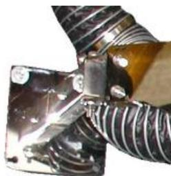
Studiato per essere smontabile e pulibile, il tubo flessibile è montato sul pantografo attraverso cinghie a strappo che rendono facile e veloce la manutenzione
