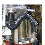
Il braccio di aspirazione mod. HS-SE-INOX-ATEX è adatto per l'aspirazione alla fonte di esalazioni, gas e polveri in ambiente a rischio esplosione (ATEX zona 1/21).
