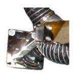
Studiato per essere smontabile e pulibile, il tubo flessibile è montato sul pantografo attraverso cinghie a strappo che rendono facile e veloce la
