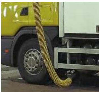
La bocchetta mod. MEN è adatta per essere collegata a calate fisse o ad arrotolatori per gas di scarico, per l'aspirazione alla fonte dei gas di scarico da veicoli a motore, in particolare mezzi pesanti, autobus e macchine movimento terra.
