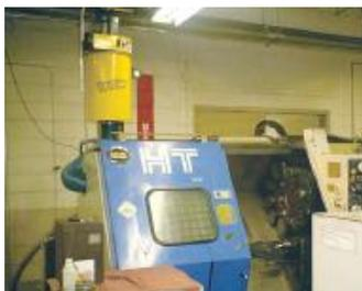
Filtro meccanico con ingresso centrifugo per abbattere le particelle più grosse, da utilizzare per la filtrazione delle nebbie oleose da piccole macchine automatiche. Soluzione perfetta per tutte quelle applicazioni che necessitano di un sistema filtrante pratico, compatto e di facile installazione.
