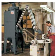
Filtri ad acqua serie NA-K, Ideali per utilizzo con grosse quantità di polveri di tipo impaccanti o infiammabili. Il sistema filtrante fatto da una miscela aria/acqua è appositamente studiato e brevettato per ottenere un'ottima resa e fermare le scintille e le particelle delle polveri in sospensione.
