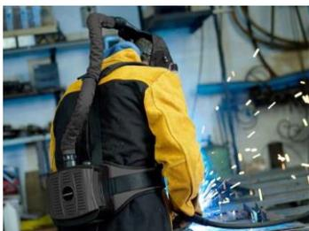
La maschera PersonalPro è realizzata per fornire la migliore protezione all'operatore durante le operazioni di saldatura e smerigliatura, con il massimo comfort. Il filtro per luce di saldatura, ad oscuramento automatico, la rende una delle maschere più all'avanguardia in commercio. Grazie all'auto-oscuramento infatti, l'operatore può saldare e controllare il pezzo senza dover continuamente alzare e abbassare il visore.
