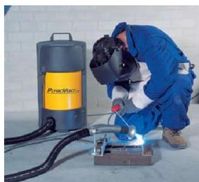
Filtro carrellato portatile, ideale per l'aspirazione dei fumi di saldatura direttamente alla fonte (da torce di saldatura, bocche magnetiche o miniproboscidi). Grazie alla sua struttura compatta, leggera (15kg) e facile da trasportare, può essere utilizzato anche in quegli ambienti confinati o difficilmente raggiungibili con altri sistemi di aspirazione.
