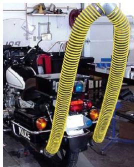
La bocchetta mod. REC è adatta per essere collegata a qualsiasi tubazione flessibile per l'aspirazione alla fonte dei gas di scarico da moto, auto e furgoni, anche con doppia marmitta di scarico.
