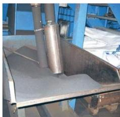
Di struttura maggiorata rispetto agli S 11000, l'unità filtrante mod. S 21000 è una soluzione ideale per grandi quantità di polvere con portate fino a 1500 m<sup>3</sup>/h.
