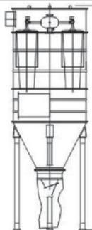
L'unità filtrante mod. S 46000 è la maggiore della gamma con i suoi 72m<sup>2</sup> di superficie filtrante, per portate fino a 8000 m<sup>3</sup>/h.
