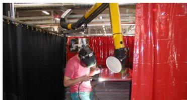
In materiale plastico, inattinico, autoestinguente. Omologate DIN-EN 1598 e DIN-PLUS, per una protezione totale contro gli UV e gli InfraRossi.
