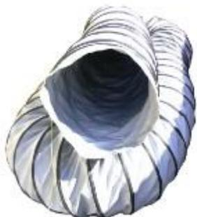
Tubo flessibile specifico per alte temperature, realizzato con tessuto in fibra di vetro alluminizzato accoppiato ad un tessuto in fibra di vetro siliconato ambo i lati, spirale metallica esterna fermata da nastro termoresistente di colore verde.
