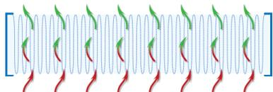
Il filtro HEPA è in grado di trattenere e filtrare fino al 99,95% delle particelle più fini e grazie alla sua ampia superficie filtrante garantisce un'ottima durata nel tempo.
