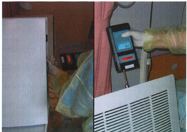
Un tecnico responsabile dell'EMSD prova l'effettiva efficienza di filtrazione di due purificatori d'aria mediante un contatore di particelle laser. La maggior parte dei convenzionali purificatori d'aria non hanno superato il test.
