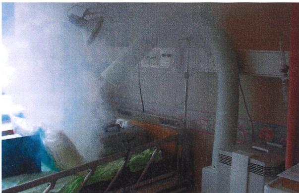
Svolgimento del test sul posto. In un letto d'ospedale viene generato artificialmente del fumo subito catturato alla fonte con l'aiuto del braccio aspirante flessibile IQAir® FlexVac™.
